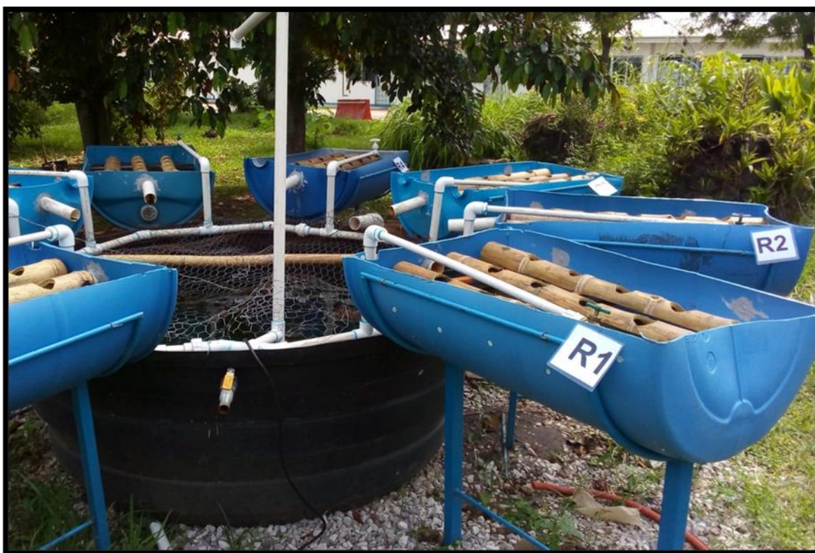
Figura 2. Sistema hidropónico desarrollado y utilizado en este estudio.
